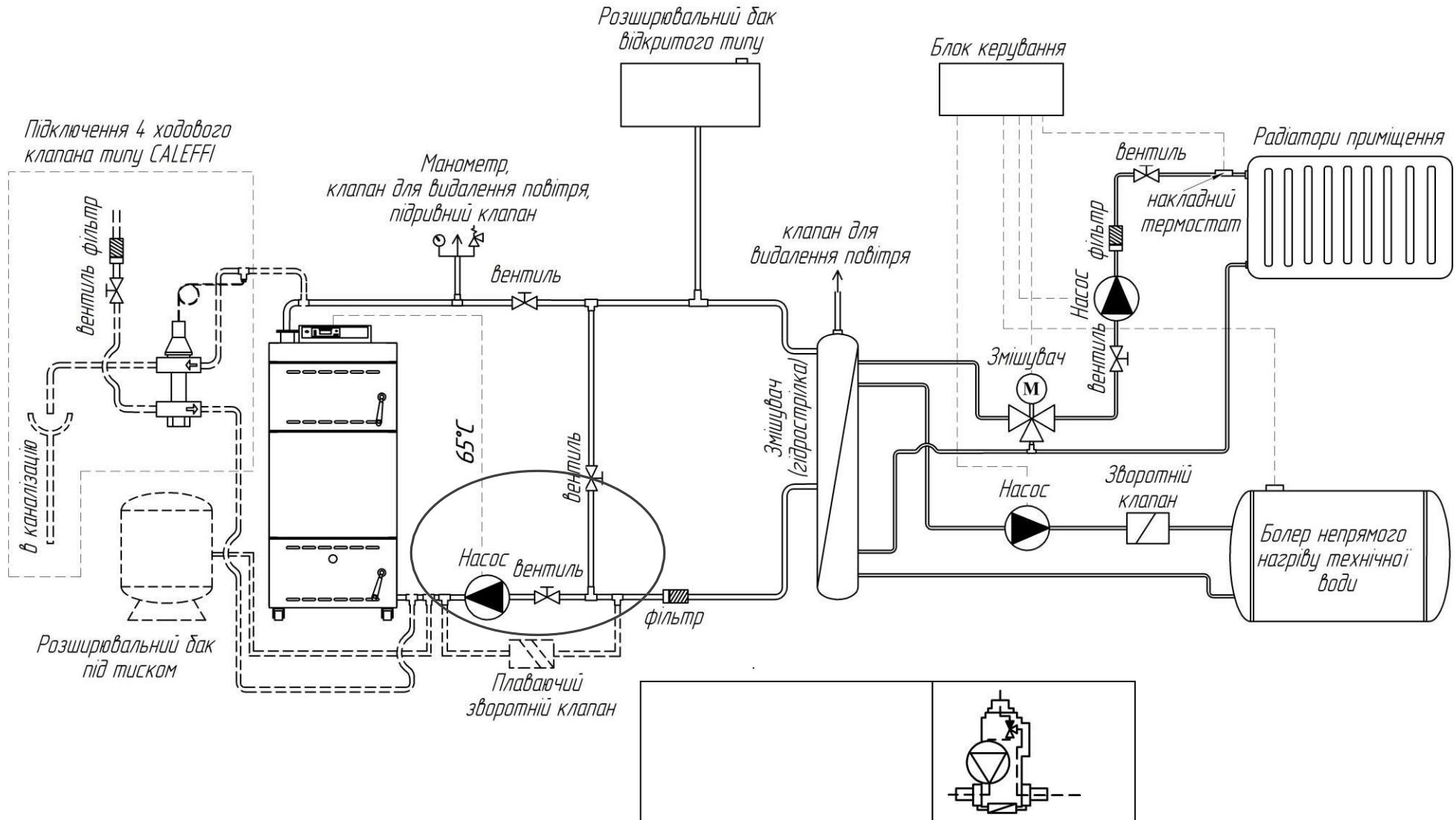
*Рекомендоване підключення котла з трьох ходовим термостатичним клапаном для підтримки температури зворотньої води не нижче 65°C*
