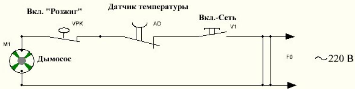
**Описание:** Схема состоит из дымососа – M1, концевого выключателя – VPK, аварийного датчика на 85° С – AD , выключателя сети - V1, Сетевой вилки - F0.
