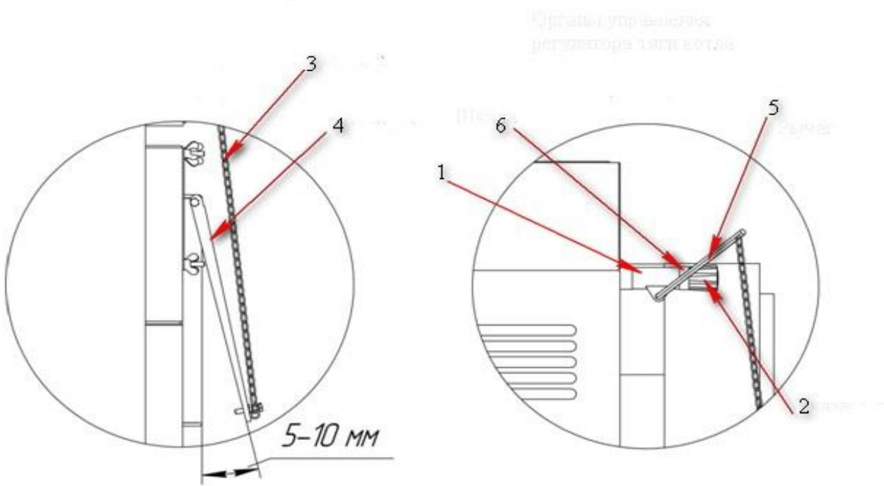
Регулятор тяги калибруется один раз. Для более корректной работы температура устанавливается с разницей в 10 градусов. Если температура устанавливается в пределах 65 – 70, то на регуляторе устанавливают 65. Так же действуют и при работе на температурах от 70 до 80 . Температура теплоносителя не может очень отличаться от установленной.
