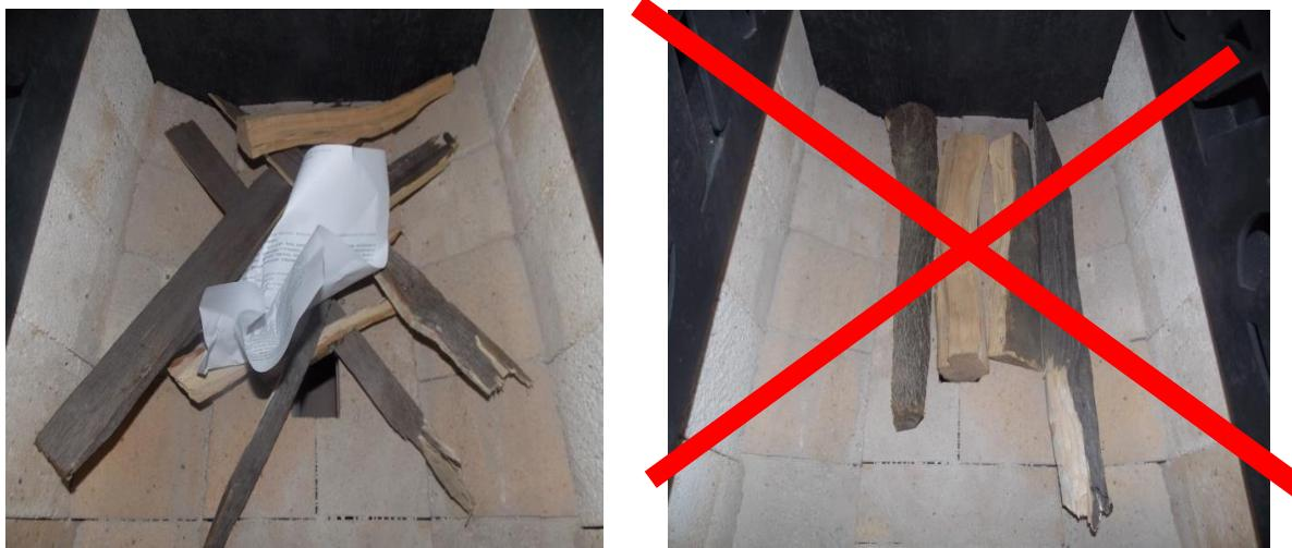
12.2 Используя факел осуществить розжиг, закрыть средние дверцы загрузочной камеры. Когда дрова достаточно разгорятся, догрузить дрова. Регулятором температуры выставить желаемую температуру теплоносителя от 65-85 °C.
