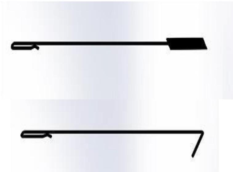
2. Скребок ( Рисунок 15) предназначен для чистки поверхностей теплообменников и внутренних стенок котла
