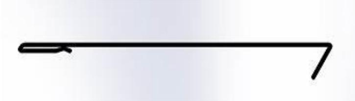
2. Скребок (рис 2) - призначений для чищення поверхонь теплообмінника і внутрішніх стінок теплогенератора
